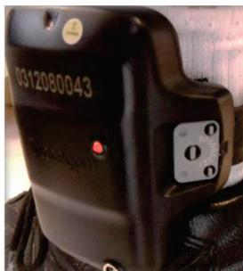
A tornozeleira irá vibrar e emitir bip a cada 5 minutos até que se coloque na tomada. Coloque-a para recarregar imediatamente. Quando a carga estiver completa a luz vermelha irá parar de piscar.
